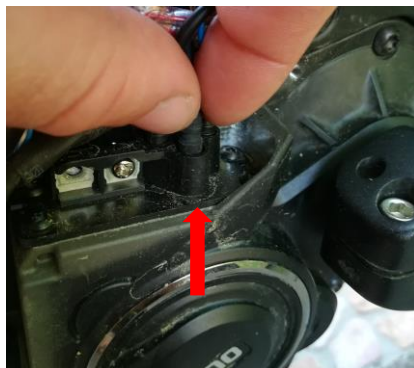
Abb. 1 Motorsteuergerätabdeckung entfernen und Ziehen des Sensor-Steckers.
