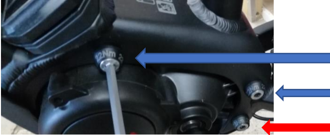
Abb. 3 Lösen des Motors Beispiel (Motor/Hersteller kann abweichen)
