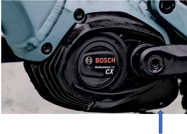
Abb. 2 Zugang zu den Steckverbindern am Beispiel eine Bosch GEN4
