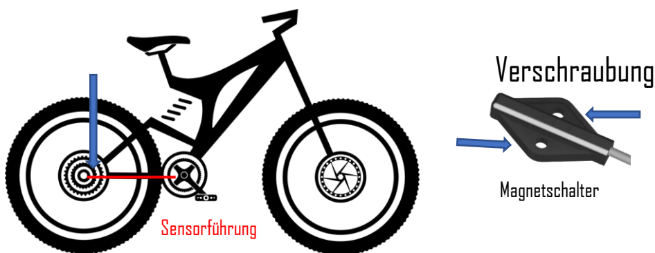
Abb. 5 Verschraubung des Sensors
