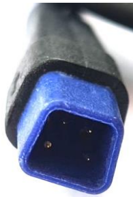
Abb. 1: Stecker des kompatiblen Geschwindigkeitsensors
