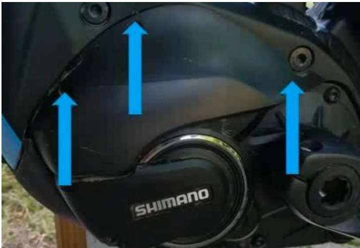
Abb. 1: Motorraumabdeckung am Beispiel eines Steps E8000
