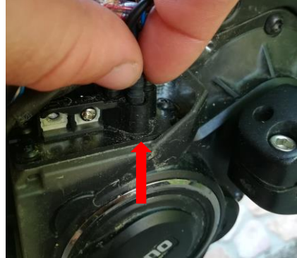
Abb. 1 Sensor-Steckers trennen (am Beispiel eines Shimano Steps Motorsystems)
