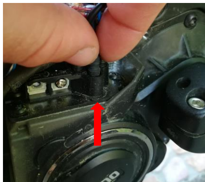
Abb. 1 Sensor-Steckers trennen (am Beispiel eines Shimano Steps Motorsystems)
