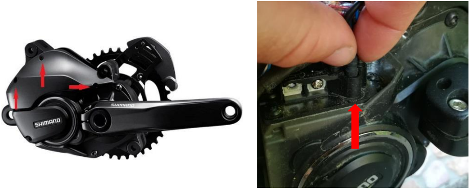
Abb. 1 Sensor-Steckers trennen (am Beispiel eines Shimano Steps Motorsystems)
