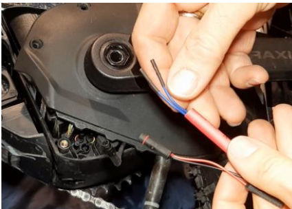
Abb. 5 Schrumpfschlauch zur Sicherung der Verbindung
