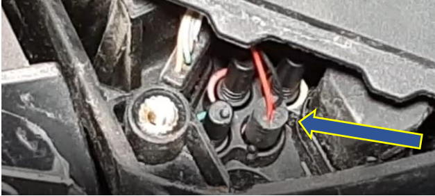
Abb. 3 Verbindungen an einem Brose Drive-S Mag (Specialized 2.1)
