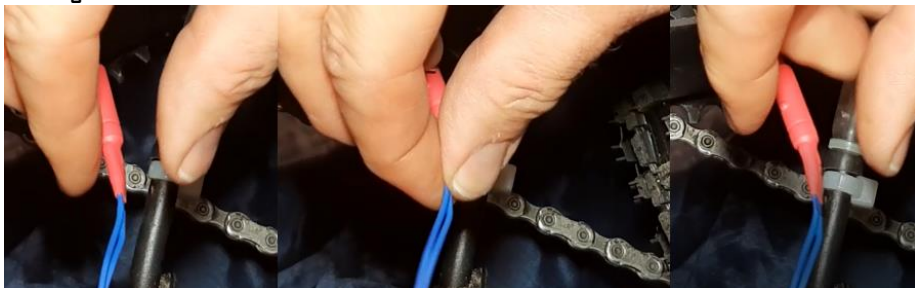
Abb. 9 Enden nach dem Schrumpfen verpressen - ! heiß !
