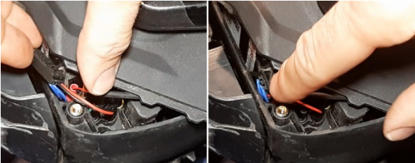
Abbildung 9: MBevo im Motorraum verstauen
