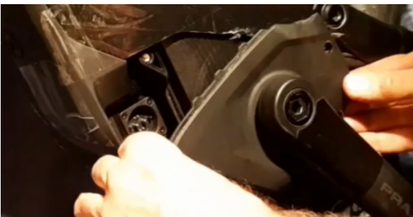
Abbildung 10: Motorschutzabdeckung wieder montiert
