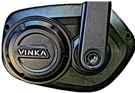
Abbildung 4: Motorschutzabdeckung wieder montiert
