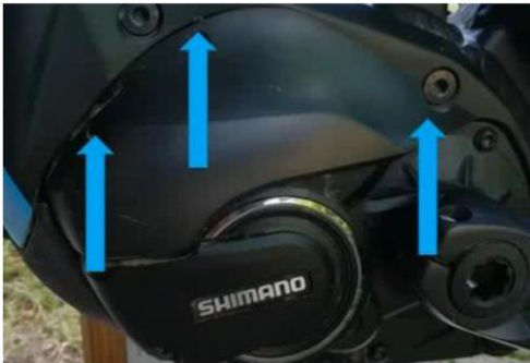
Abbildung 6: Motorschutzabdeckung wieder montiert
