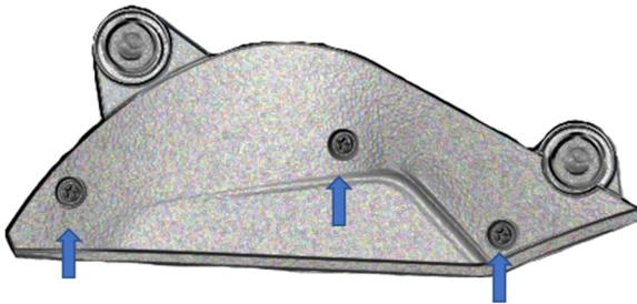
Abbildung 6: Motorschutzabdeckung wieder montiert
