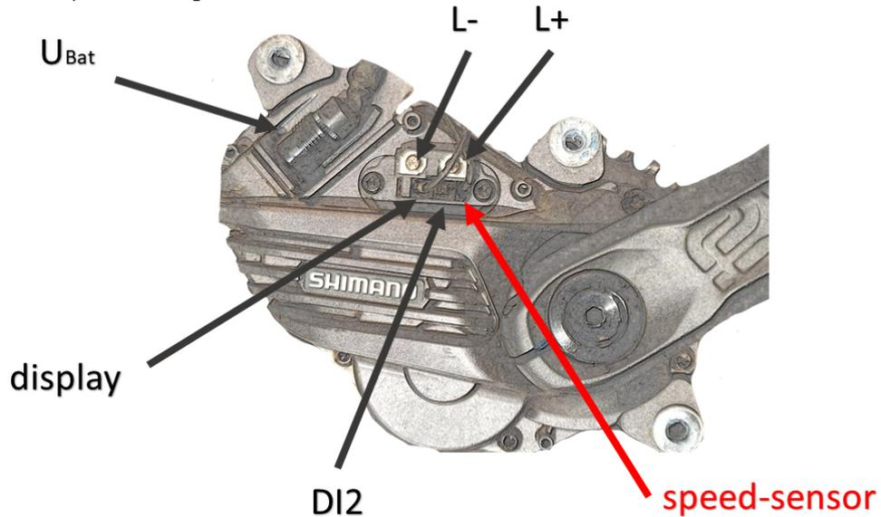
Abbildung 2: Steckerposition des Geschwindigkeitssensors
