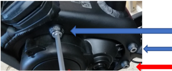
Abbildung 4: Motorschutzabdeckung wieder montiert / Motor befestigen
