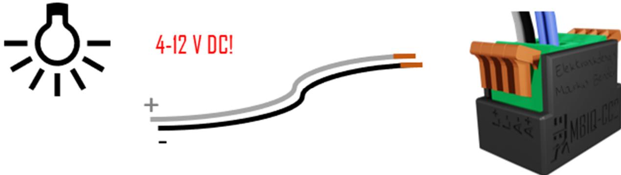
Abbildung 6: Lichtsignal Anschluss
