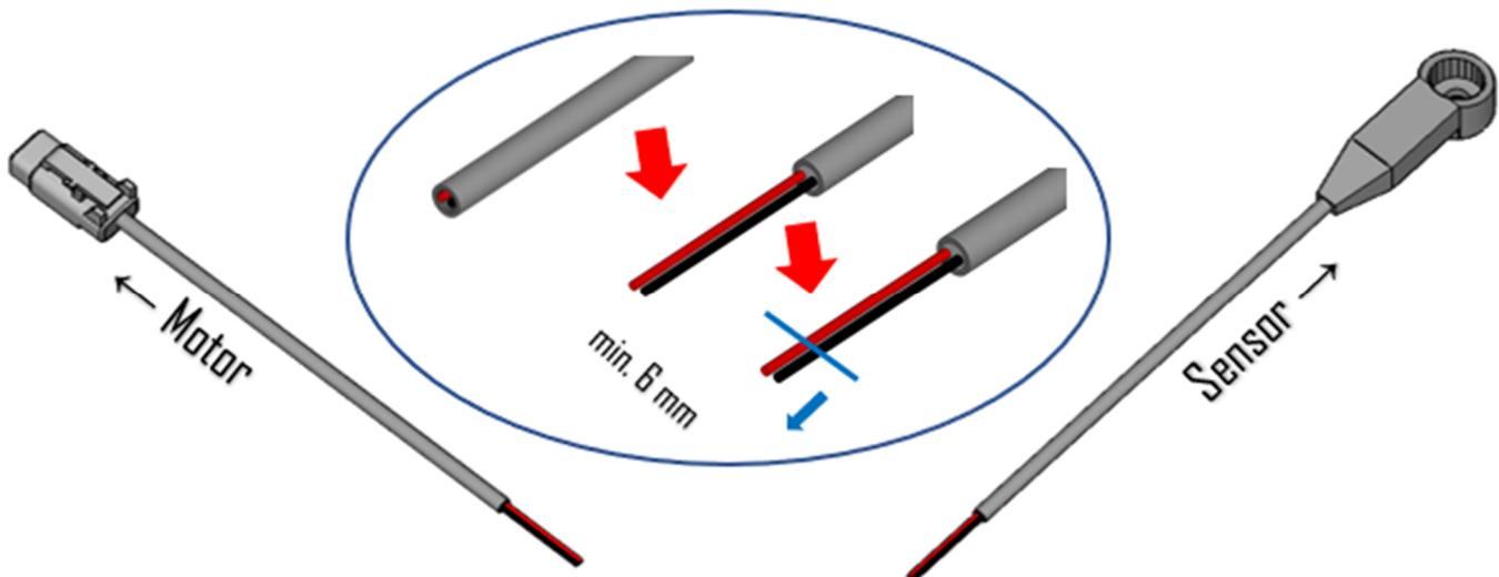
Abbildung 3: Kabel abisolieren
