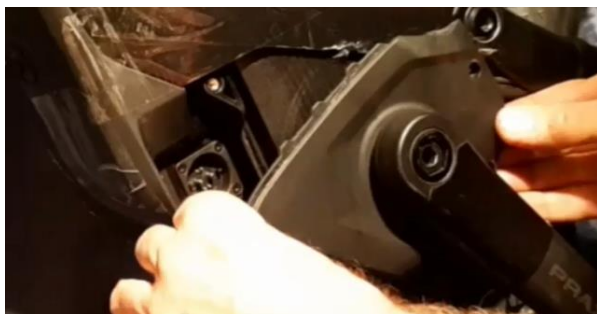
Abbildung 7: Motorschutzabdeckung wieder montiert
