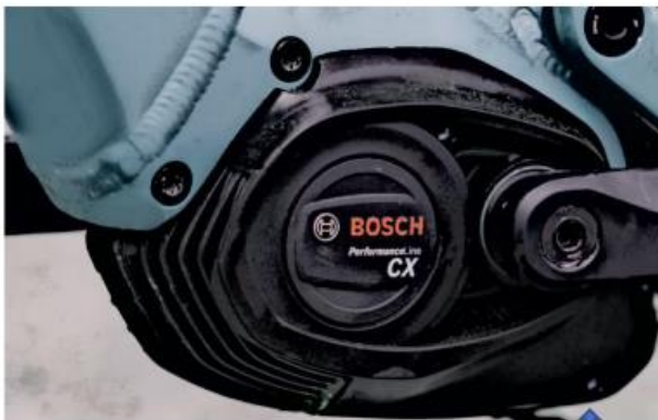
Abbildung 4: Motorschutzabdeckung wieder montiert
