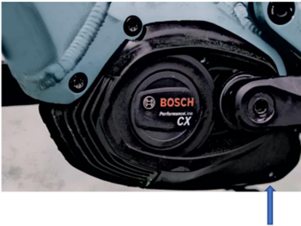
Abbildung 5: Motorschutzabdeckung wieder montiert
