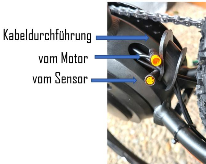
Abbildung 2: Geschwindigkeitssensor Steckverbindung
