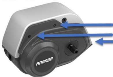
Abbildung 4: Motorschutzabdeckung wieder montiert
